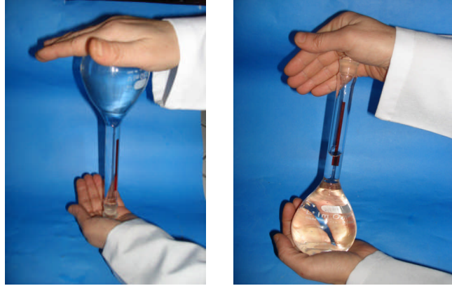
Resim 1.12: Balon jojeyi çalkalama
