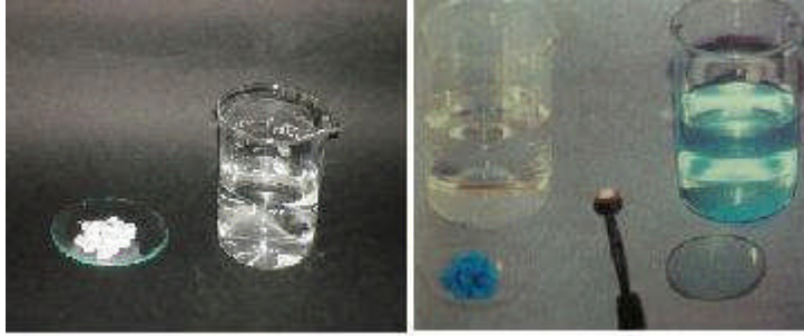
Resim 1.9: Katı çözünen maddenin beherde çözündürülmesi
