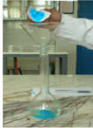
Resim 2.3: Çözünen maddenin balon jojeye aktarılması
