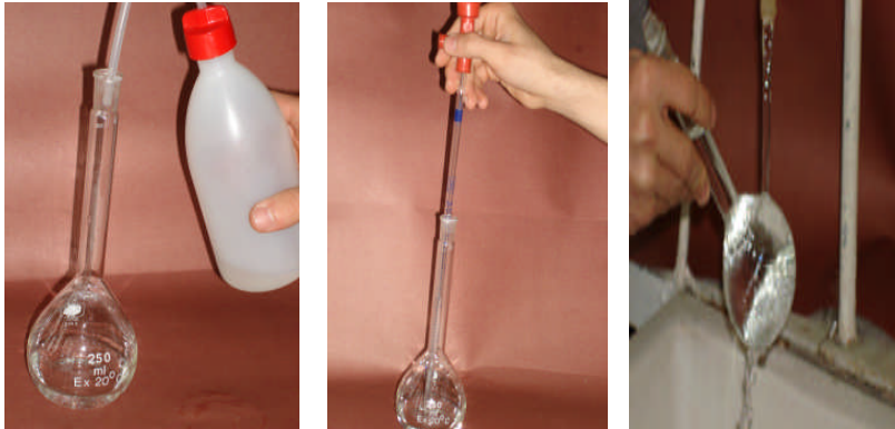
Balon jojeye saf su alma Asidi yavaşça ekleme Soğutma işlemi Resim 1.13: Asitle çözelti hazırlama aşamaları ve soğutma işlemi
