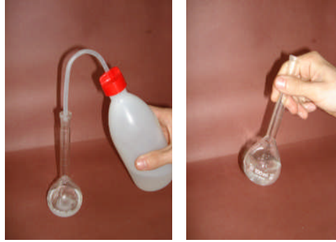
Resim 2.4: Çözünen maddenin balon jodede çözündürülmesi
